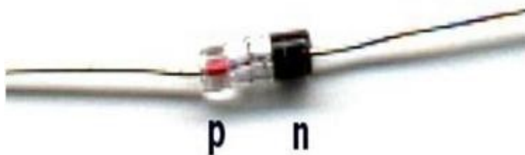
شکل ۸: یک دیود واقعی که از یک پیوند p-n تشکیل شده است.
